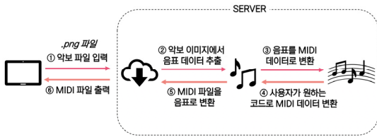
그림 6. 조 변환 시스템 수행 시나리오 Fig. 6. Scenario of Chord Conversion System
