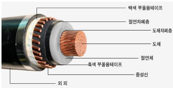
Fig. 1. CNCV 케이블의 구조
