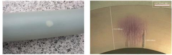
Fig. 13. 절연체 수트리(좌) 보라색 수트리 및 검은색 전기트리(우)
