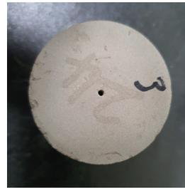
그림 2. 불연성능 시험 온도가열 곡선 및 시험체
