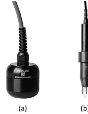
그림 3. 제어 시스템에서 사용한 센서들 (a) 용존 산소 센서 (b) pH 센서 Fig. 3. Sensors used in control system (a) Dissolved oxygen sensor (b) pH sensor
