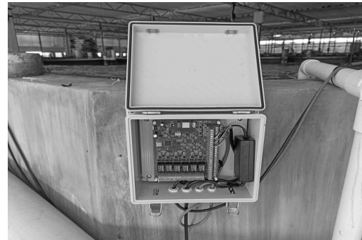
그림 7. 양식장에 설치한 센서 수집기 Fig. 7. Sensor gatherer installed at the fish farm
