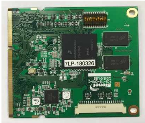
그림 2. 중앙처리장치 모듈 보드 Fig. 2. Main CPU Module Board
