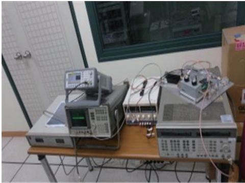
그림 6. 초기 시험용 샘플링 시스템의 성능을 확인하기 위한 실험 모습
