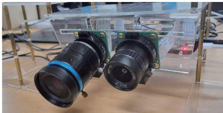
그림 3. 이중초점 스테레오 카메라 시스템 Fig. 3 Bifocal stereo camera system
