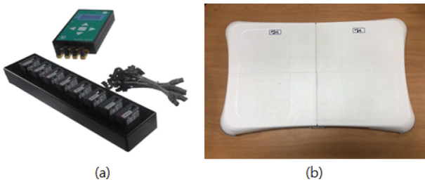
그림 2. 측정도구 (a)근전도, (b)Wii 균형 측정판 Fig. 2. Measurement equipment (a)EMG equipment (Noraxon, USA), (b)Wii® Balance Board (Nintendo, Japan)
