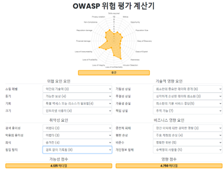
(그림 9) 침입탐지가 검토없이 기록된 경우의 위험평가 계산 (Figure 9) Calculation of risk assessment when intrusion detection is recorded without review
