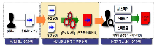
(그림 4) 음성분석 및 합성 프로그램을 이용한 공격모델 (Figure 4) Attack Model using Voice Analysis and Synthesis Software
