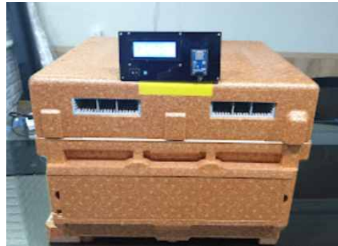
그림 11. 벌집 입·출입 계수 시스템과 모니터링 패널 Figure 11. Honeycomb entry and exit counting system and monitoring panel
