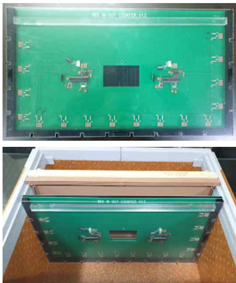
그림 10. 벌집 입·출입 계수 시스템 Figure 10. Honeycomb entry and exit counting system
