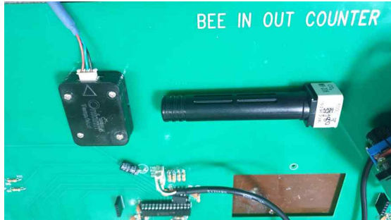
그림 9. 확장된 공간에 추가 장착이 가능한 센서 Figure 9. Sensors that can be further inserted into the expanded space
