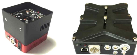
그림 2. 스타트래커의 센서 유닛(좌)과 프로세서 유닛(우) Figure 2. The sensor unit (left) and the processor unit (right) of the Startracker
