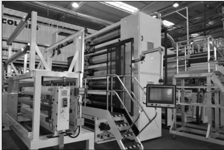
[사진 2] MDO유닛은 리와인더(rewinder) 전단에 위치하며 필름을 가열하는 히팅 롤(Heating roll)과 가열된 필름을 식혀주는 쿨링 롤(Cooling roll)이 연속으로 조합된 형태로 구성되어 있다.
