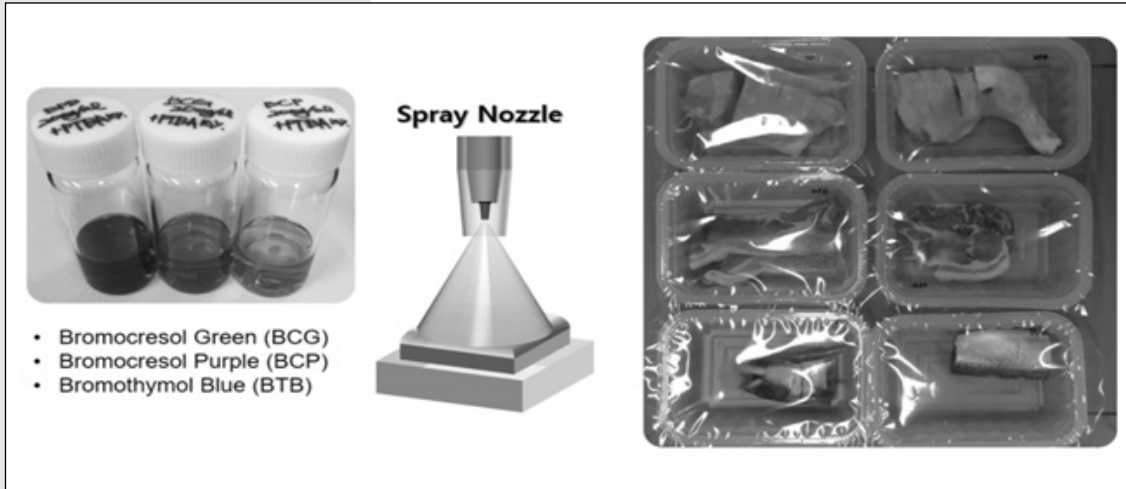
[그림 7] 저점도 색-변환 잉크를 이용한 센서 제조를 위해 스프레이코팅방법을 이용해 신선도 표시계를 제조하고, 그에 대한 센서특성을 평가했다.
