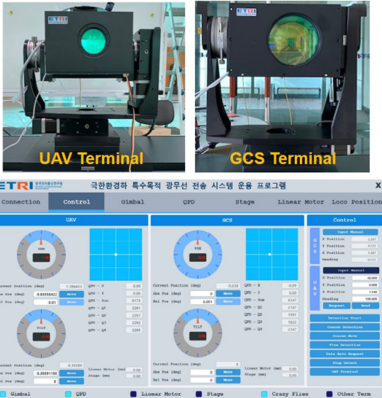
그림 5 ETRI UAV 기반 모바일 FSO 시제품 및 운용 시스템
