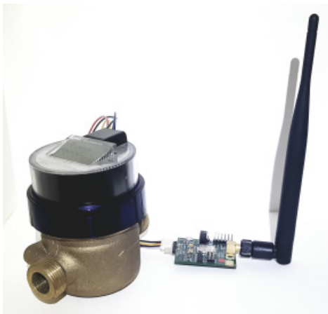
그림 4. 디지털수도미터와 LoRa 통신모듈 연결 Fig. 4 The Connection of LoRa RF module and water meter
