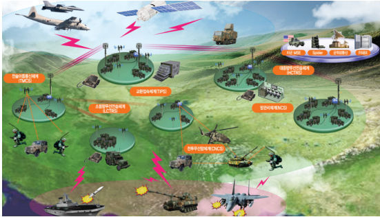
그림 1. 전술정보통신체계(TICN)의 구성도 Fig. 1 Structure of TICN system.
