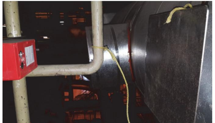
좌측 적색 상자가 라이다 센서이다. 센서는 우측 큰 파이프에 레이저를 조사하여 반사된 신호가 되돌아 올때까지 걸리는 시간을 측정한다. 파이프에 붙어 있는 철판은 레이저의 반사를 높여 측정 오류를 줄인다. ATCO 제공.
