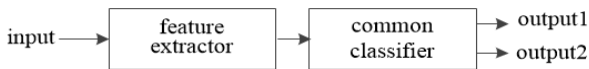
그림 1. 공용 인식기를 사용하는 다중 정보 인식 구조 Fig. 1. Structure of multiple information recognition using common recognizer
