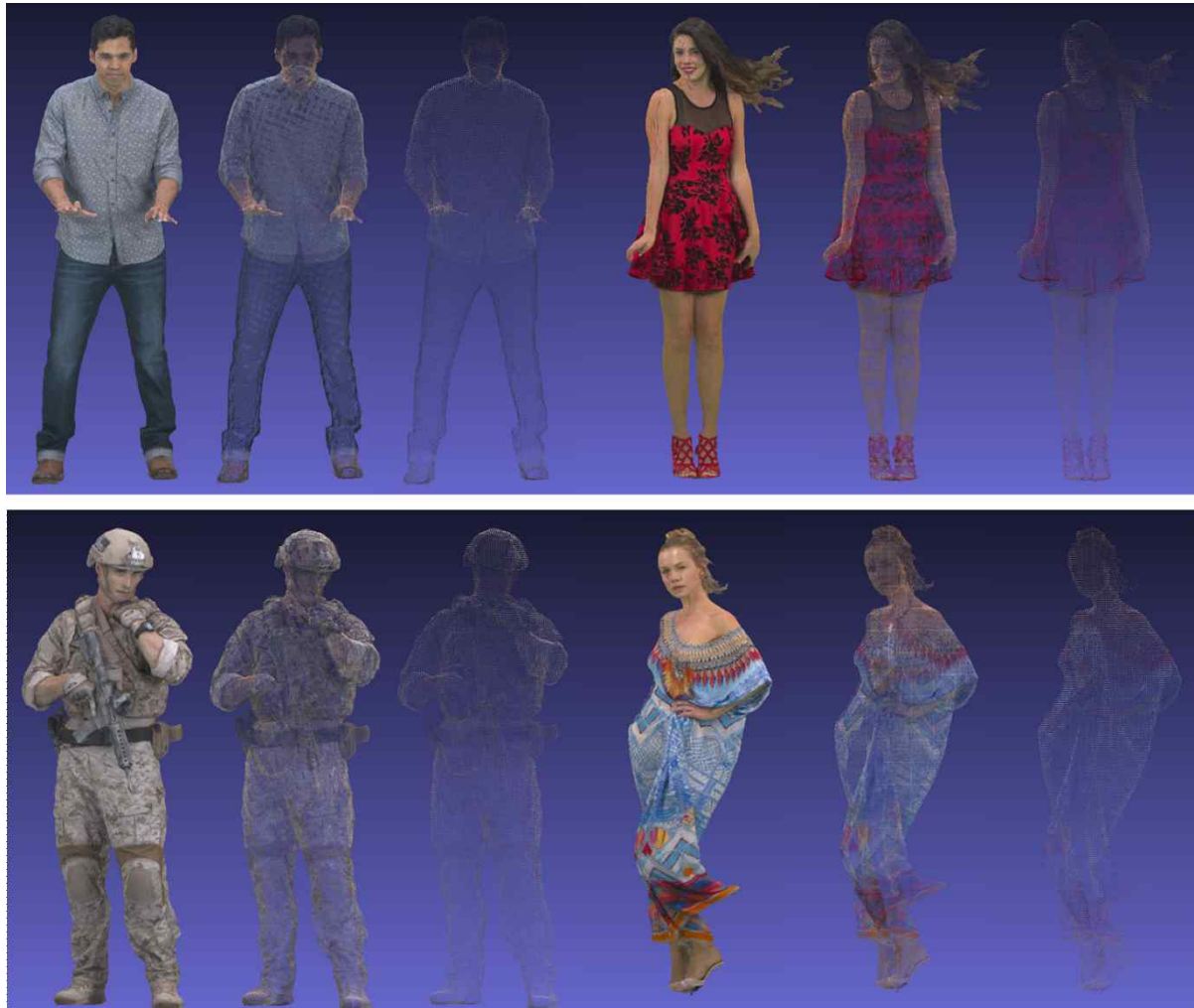
그림 10. 밀도 스케일러빌리티를 적용한 포인트 클라우드 결과 예시 Fig. 10. Example of point cloud reconstruct data applying density scalability
