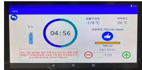
Fig. 7. GUI that Proceeds after Session Selection. 그림 7. 세션 선택 후 진행되는 GUI
