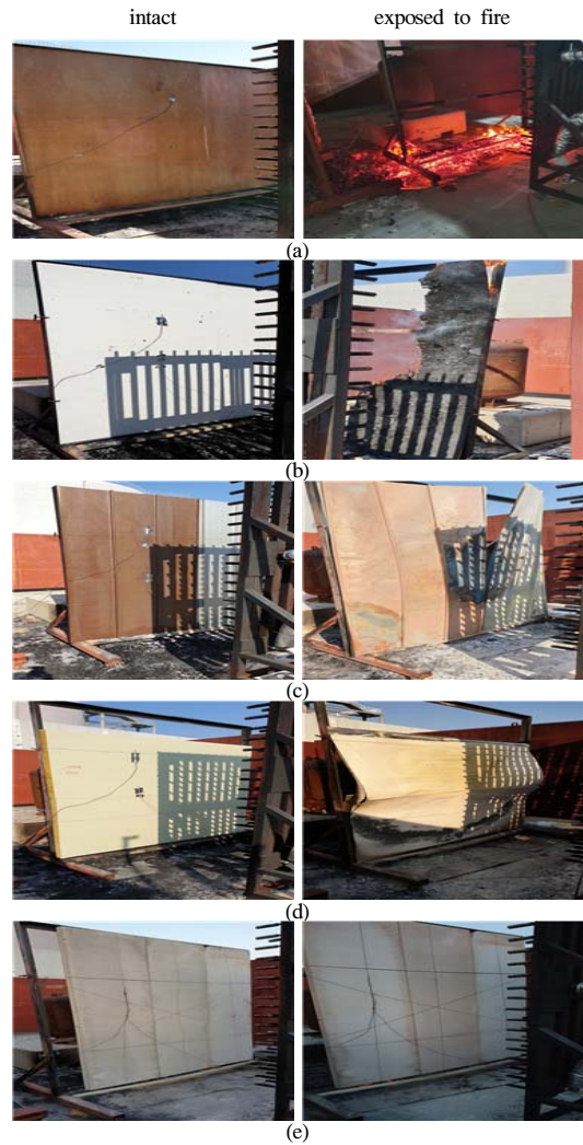
Fig. 3. Photos of firewalls used in the tests: (a) LWD, (b) LWC, (c) EPS, (d) GWS, (e) ALC.
