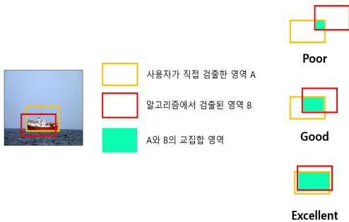
(그림 13) 검출 영역 A와 B에 따른 IoU 값의 평가 (Figure 13) Evaluation of IoU values by Detection Area
