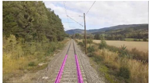
(그림 9) 융합 알고리즘을 이용한 철도 레일 탐지 결과
