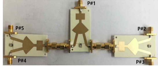
그림 8. 직렬 연결한 원형 부채꼴 분배기-결합기 사진
