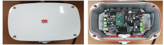
그림 7. oneM2M기반 게이트웨이 Fig. 7 oneM2M based gateway
