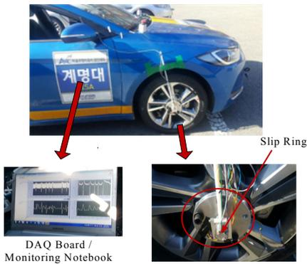
그림 8. 타이어 변형량의 유선 계측 시스템
