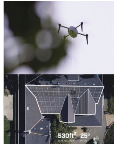
그림 2. 케스프리 드론의 지붕 손상 촬영 [27]
