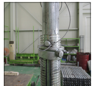
(d) Internal thread destruction
