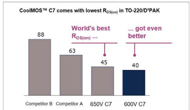
그림 12 TO-220/D²PAK에 가장 낮은 R_{ds(on)} 을 구현
