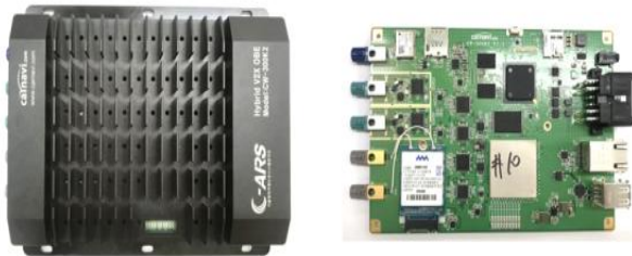
그림 2. 하이브리드 V2X 통신단말기 제작결과 Fig. 2. Implementation result of hybrid V2X communication terminal.
