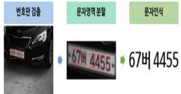
그림 1. 번호판 인식시스템 과정
