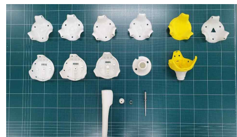
그림 4. 3D 프린팅을 이용한 케이스 제작
