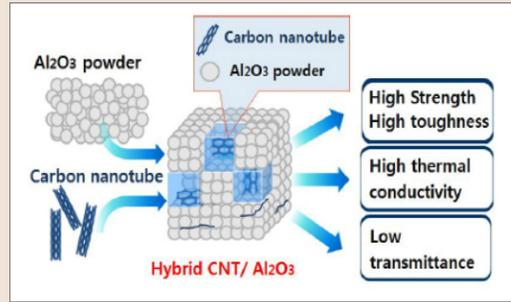
그림 4 ▶ 하이브리드 CNT/Al<sub>2</sub>O<sub>3</sub> 복합소재 제조 모식도 및 복합소재의 특성.
