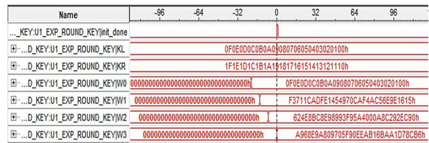
그림 11. 키 초기화의 시그널 탭 결과 Fig. 11. Signal tap result of key initialization.
