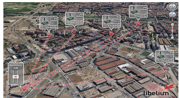
그림 1. 도시 중심에서의 LoRaWAN 통신 실험 환경 Fig. 1. LoRaWAN communication experiment environment in the city center.
