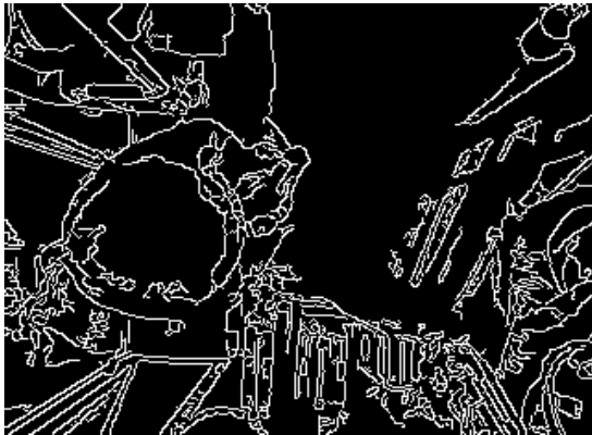
(그림 1) Canny Edge Detection으로 추출된 승객 (Figure 1) Passengers extracted with Canny Edge Detection
