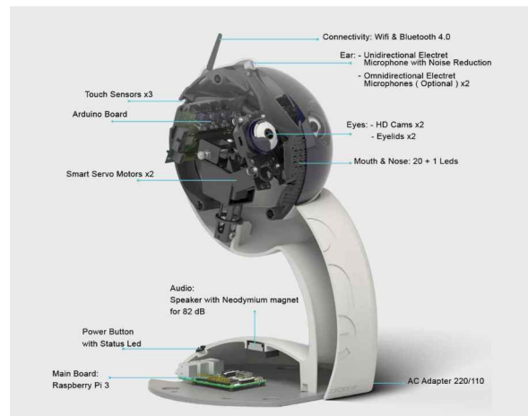
그림 1. Q.bo one의 구조 Figure 1. Structure of Q.bo one
