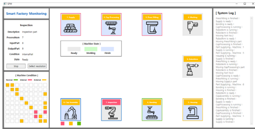
그림 8. 설비 7과 관련된 설비들이 외부 오류를 나타낸 모습 Fig. 8. External failure in facilities related to facility 7
