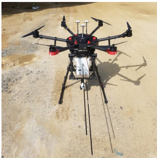
그림 2. 미세먼지 측정을 위한 구조 Fig. 2 Inlet structure for fine dust measurement
