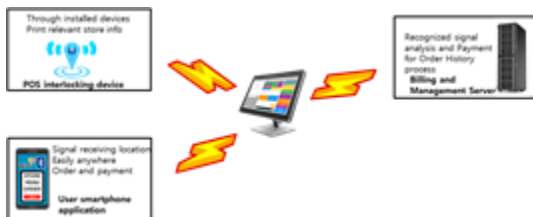
그림 2. 근거리 무선 통신 비대면 주문 및 결제 시스템 구성도
