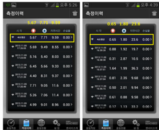
그림 9. 상용 AP 안테나 대비 SPA 평균 전송속도 Fig. 9 Average SPA transmission rate compared to commercial AP antenna
