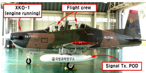
그림 11. 체계 내 전자기 적합성 시험 사진 Fig. 11. Picture of intra-system EMC test.
