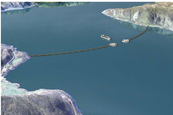
〈그림 3〉 부유식 교량 및 터널 복합 방식(좌), 중앙 교차부분 상세 개념도(우)
