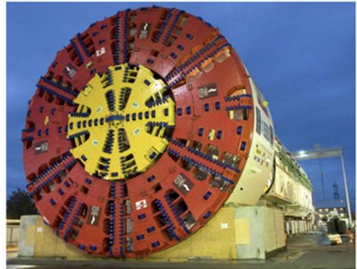
〈그림 7〉 이중 Cutter head
