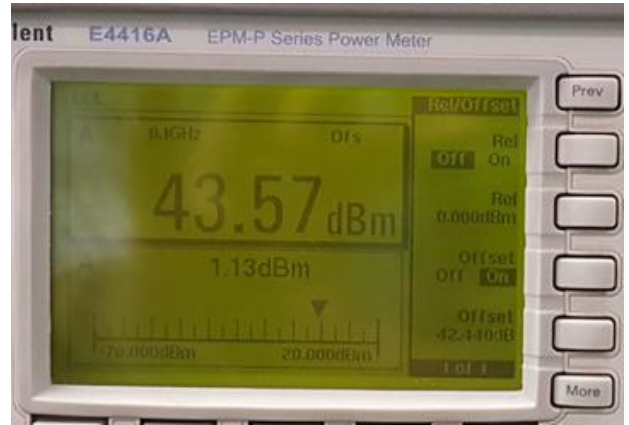
Fig. 20. Maximum Output Power Characteristic of BUC. 그림 20. BUC의 최대출력파워 특성
