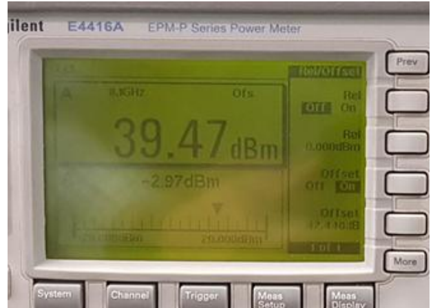
Fig. 19. Gain Characteristic of BUC. 그림 19. BUC의 이득 특성
