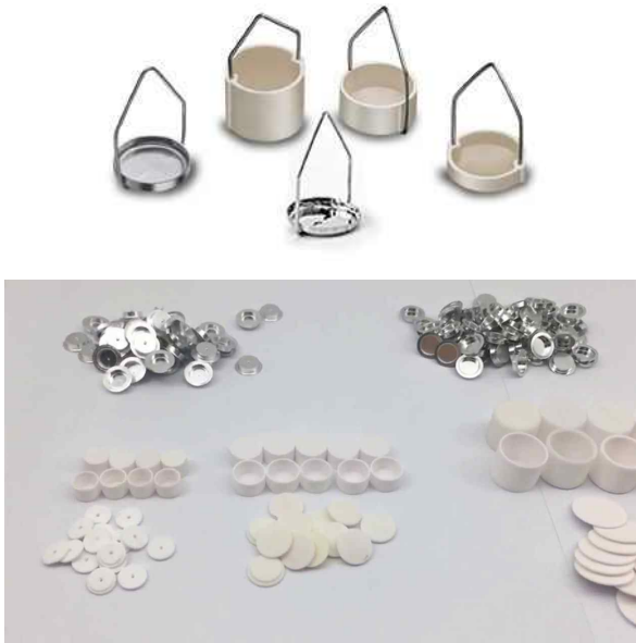
그림 2. TGA용 시료 용기. 위 사진은 시료 용기를 저울에 걸어서 사용하는 것이고, 아래 사진은 시료 용기를 저울판에 위에 올려 사용하는 것이다.
