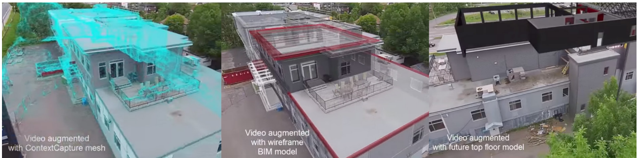
그림 6. 증강현실, BIM, 드론의 3차원 모델 접목을 통한 건설 프로젝트 진행 모니터링 시스템 [13]
