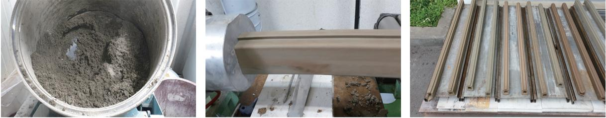
그림 6. 화학적 처리된 시료 혼합 압출성형 패널 제작
