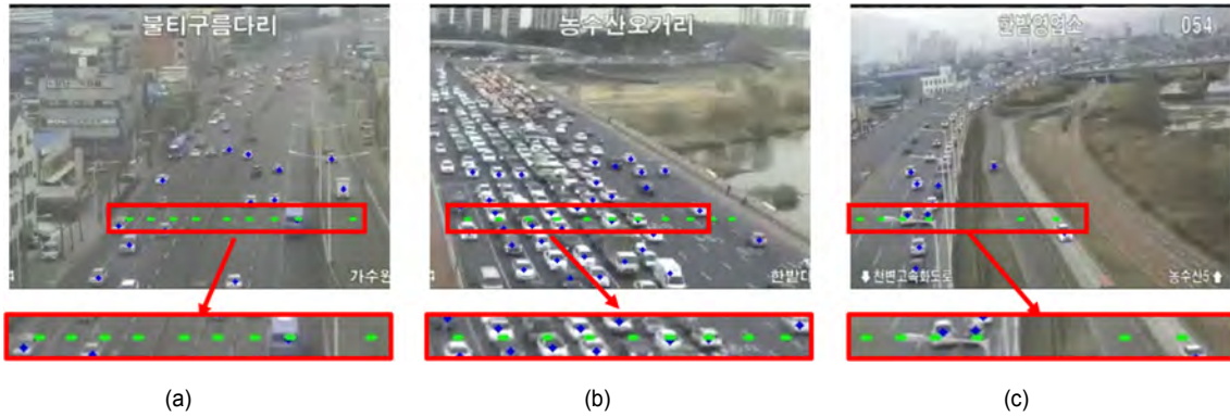
그림 5. 차로별 중앙 지점 검출 결과 (a) 원활한 교통상황의 경우. (b) 교통 체증상황의 경우. (c) 복잡한 도로 형태의 경우. Fig. 5. Results of the center detection (a) Case of smooth flow. (b) Case of traffic congestion. (c) Case of Complex road form
